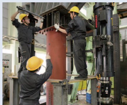
高速道路を支える柱を使った実験
