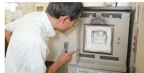
▲1600℃までの高温で使える実験用の電気炉
