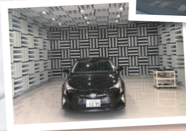
実車を用いて防音性能を評価する音響室
