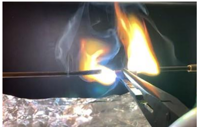
プラズマ状態となった大気に電流が流れ続ける →アーク放電
