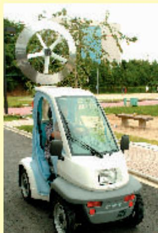
電気自動車を利用した集風実験装置。風力発電で走る車を目指します
