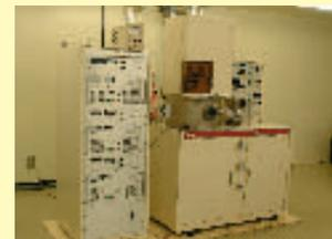
RFスタッキング装置。超伝導材料の作成に使用します
