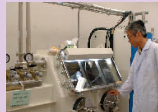
電池の容量や性能を測定するバキュームグローブボックス装置
