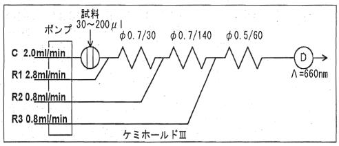
注. C:6%硫酸 (ブランク液)、R1:モリブデン酸アンモニウム液、R2:純水、R3:アスコルビン酸液
