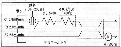
注. C:6%硫酸、R1:2.5M水酸化ナトリウム液、R2:Tecatorアンモニア指示薬。
