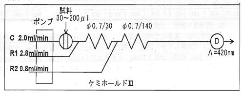
注. C:6%硫酸 (ブランク液)、R1:純水、R2:バナドモリブデン酸液
