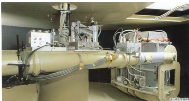
遠心模型実験装置 (容量: 15g-ton)
