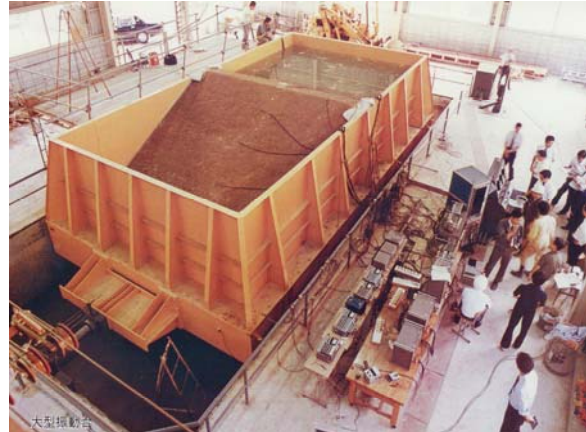
震動台実験装置 (寸法: 11m×6m)
