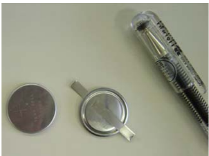
TOT類を使って開発した、レアメタルを必要としない「分子スピン電池」。従来のリチウムイオン電池と比べると最大2倍の容量の電気エネルギーの充放電ができる。
